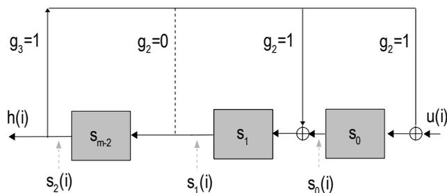
Hält man den rechten Eingang immer auf  $u(i)=0$ , belegt wenigstens eines der Speicherelemente mit dem Wert „1“ und startet dann das Schieberegister, so erhält man eine „zufällige“ binäre Folge, die sich erst nach  $2^3 - 1 = 7$  Werten wiederholt.
