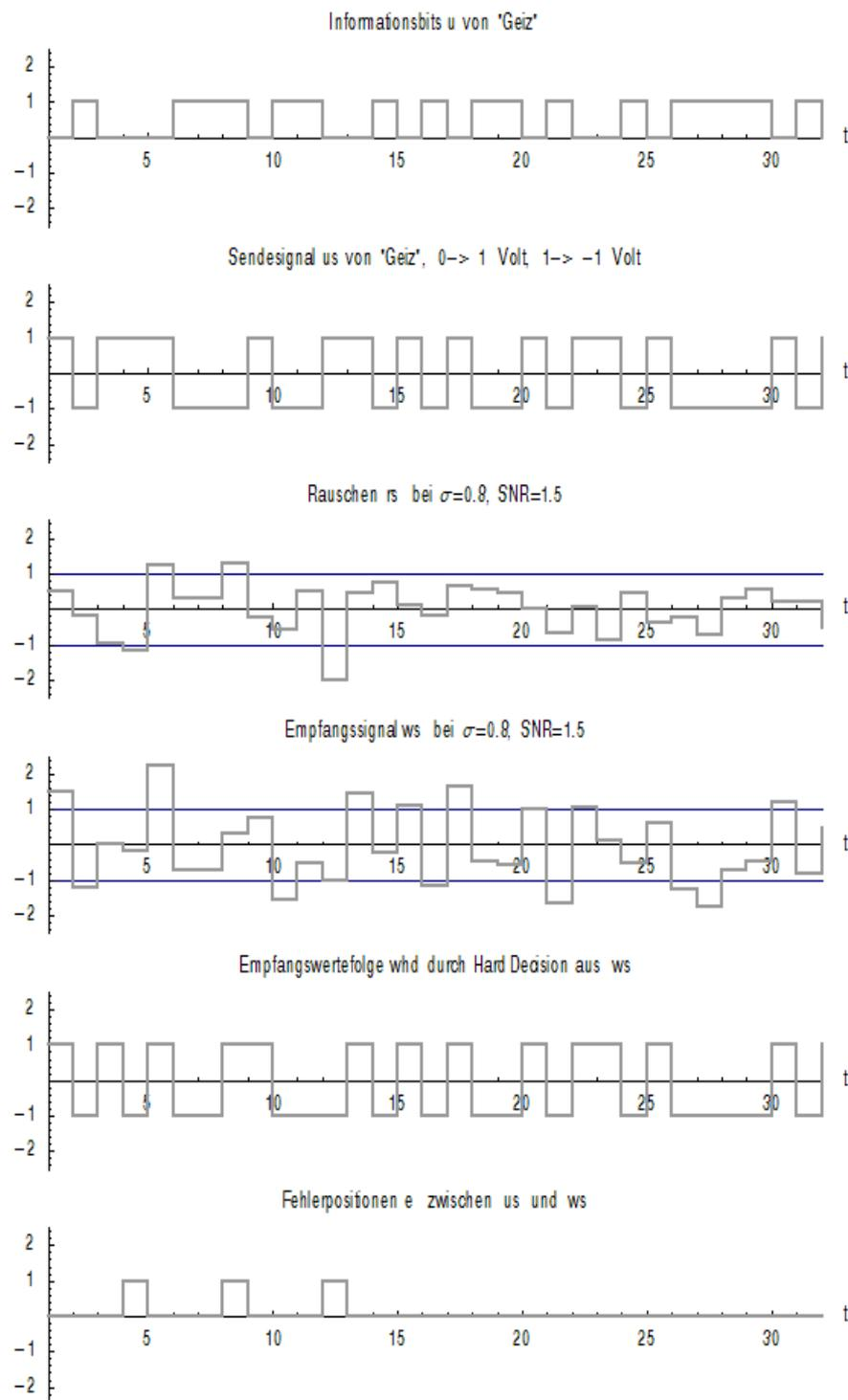
**Signale eines Datenübertragungsprozesses bei einem Kanal mit SNR = 1.5 (Signal to Noise-Ratio). Der Empfänger muss aus dem Empfangssignal  $w_s$  versuchen, eine solche Empfangswertefolge zu gewinnen, dass diese der Sendesignalfolge möglichst fehlerfrei entspricht. Da kein Kanal rauschfrei ist, gelingt dies nur durch Erweiterung der Informationsbitfolge mit geeigneten Prüfbits.**
