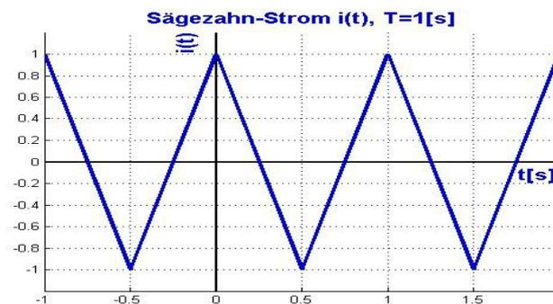
Geben Sie die Fourierkoeffizienten bis zur zweiten Oberschwingung des im Diagramm skizzierten Sägezahn-Stromes  $i(t)$  an:
