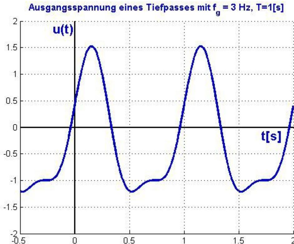
Da  $u(t)$  wegen der Bandbegrenzung bei der Fourier-Reihendarstellung keine Oberschwingungen über 3 Hz enthalten kann, werden aus dem Oszillogramm im Abstand  $\frac{T}{6}$  6 Werte abgelesen:
