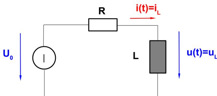
Die speisende Gleichspannung  $U_0$  hat für  $t < 0$  den Wert  $U_0(t < 0) = 0$ , sonst  $U_0(t \geq 0) = 5 \text{ [Volt]}$ , außerdem fließt für  $t < 0$  kein Strom,  $i(t < 0) = 0$ .
