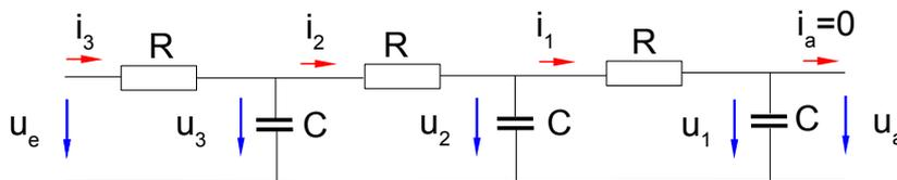
Wegen der 3 Kondensatoren als Energiespeicher und des Gesetzes  $i_c(t) = \frac{C \cdot du_c}{dt}$  liegt als Zusammenhang zwischen Ausgangs- und Eingangsspannung  $u_a = f(u_e)$  eine gewöhnliche, lineare, inhomogene DGL dritter Ordnung mit konstanten Koeffizienten vor.
