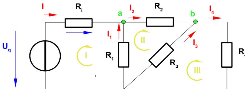
mit  $U_q = 100 \text{ V}$ ,  $R_i = 10 \text{ Ohm}$ ,  $R_1, \dots, R_4 = 100 \text{ Ohm}$ .
