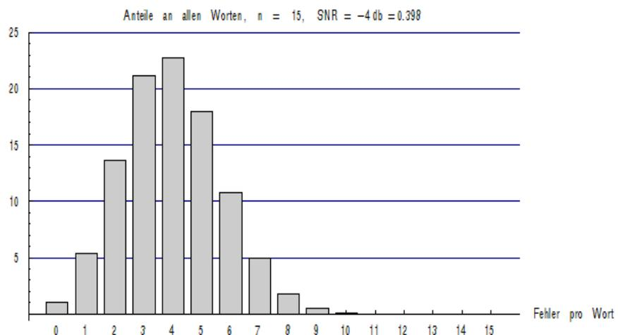
**Hinweis:** Mit dem (15,5,7)-BCH-Code werden alle Codewörter mit 1, 2 und 3 Fehlern korrigiert, ihr Anteil erhöht die fehlerfreien Wörter mit  $i = 0$ . Da die Korrektur in jedem Fall aber
